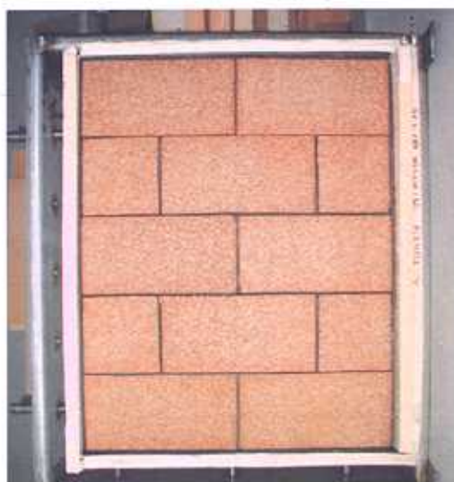
Figura 3: Pannello sottoposto a prova al termine dei cicli di gelo/disgelo
