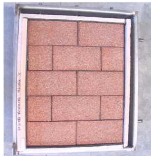
Figura 2: Pannello sottoposto a prova
